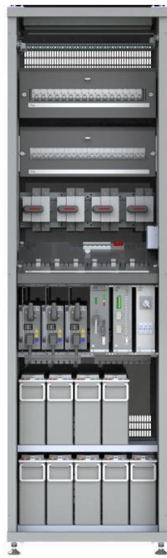
OPUS HE 110-6.0 OC2066 110VDC 18,5A – 111A Инверторы до 3,6кВт Батарейные автоматы 2 x 125A Место для батарей и распределения нагрузки
