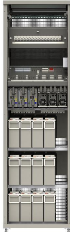
OPUS HE 48-6.0 OC2066 48VDC 41,7A – 125A DC/DC конверторы 3 x 750Вт. Батарейные автоматы 2 x МССВ 125A. Место для батарей и распределения нагрузки
